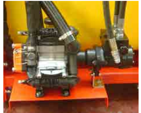
Pompe de 120 l/min + moteur hydraulique
