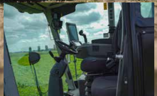
Claas cabine: geluidsloos, geveerd, Cruise Control, Grammerstoel en passagiersstoel
